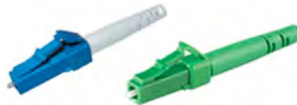
Abbildung 52: LC-Stecker mit PC-Schliff (blau) und mit APC-Schliff (grün)
